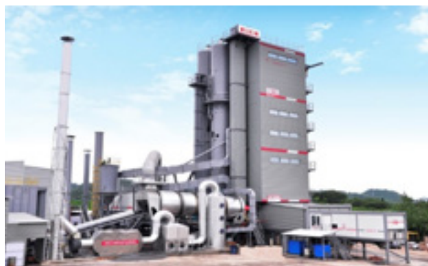
Рис. 3. Асфальтосмесительная установка компании XRMG (Китай) в комплектации с системой экологичного производства асфальтобетонной смеси
